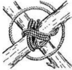
Перехресне в'язання. Починай теслярський вузол навколо обидвох палів. Обкручуй лінву навколо обидвох розгалужень. Закінчи вісімкою
